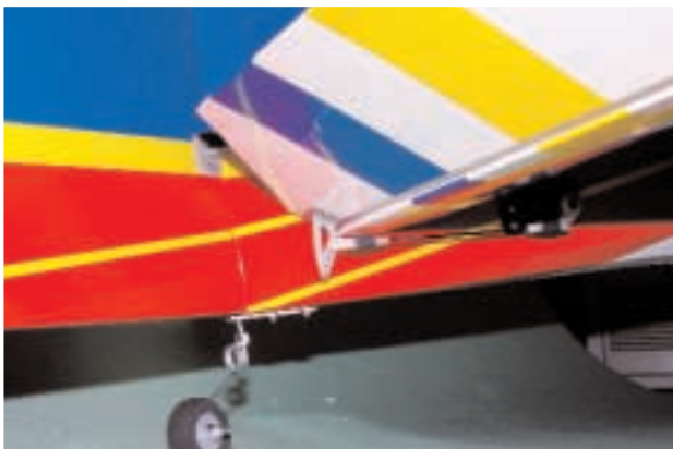
Genügend Ausschlag des Höhenruders bei 45 Grad Servoweg
