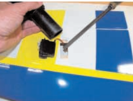
Staub absaugen ist bei Nacharbeiten an den Flächen unerlässlich
