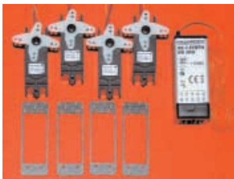
Rückstellgenaue Digitalservos und ein besonders zuverlässiger Empfänger sorgen auch in kritischen Empfangsumgebungen für Sicherheit
