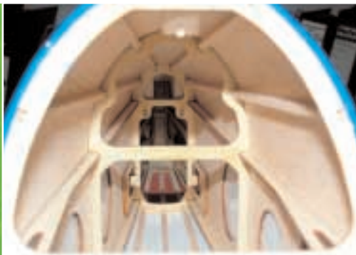
Rumpfrückeninnenansicht mit Führungsröhrchen für die Seitenrudieranlenkung
